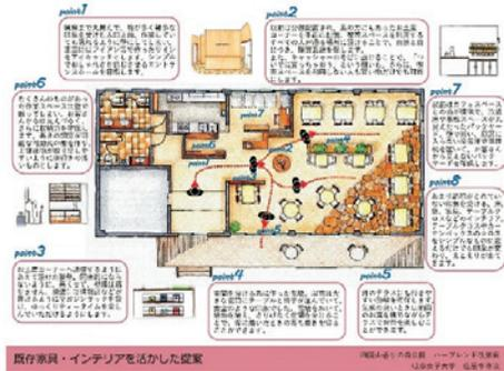
図3 ハーブレンド改修案平面スケッチ
