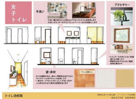
図4 ハーブレンドトイレ改修案イメージ図
